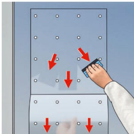
**8** Trägerfolie von oben nach unten und von der Mitte nach außen faltenfrei anreiben, Deckfolie nach und nach abziehen
