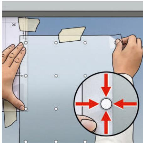
**5** Folie an Schablone ausrichten, mit Tape und an der Ecke fixieren
