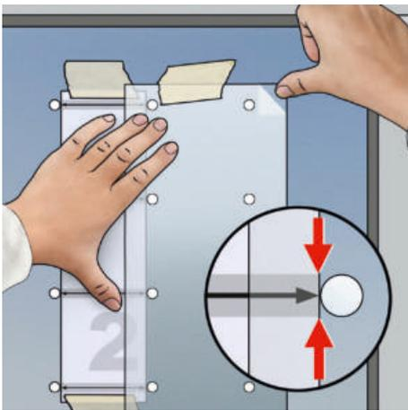
**13** Letzte in Schritt 4 zugeschnittene Folienbahn an der Schablone ausrichten, mit Tape und an der Ecke fixieren
